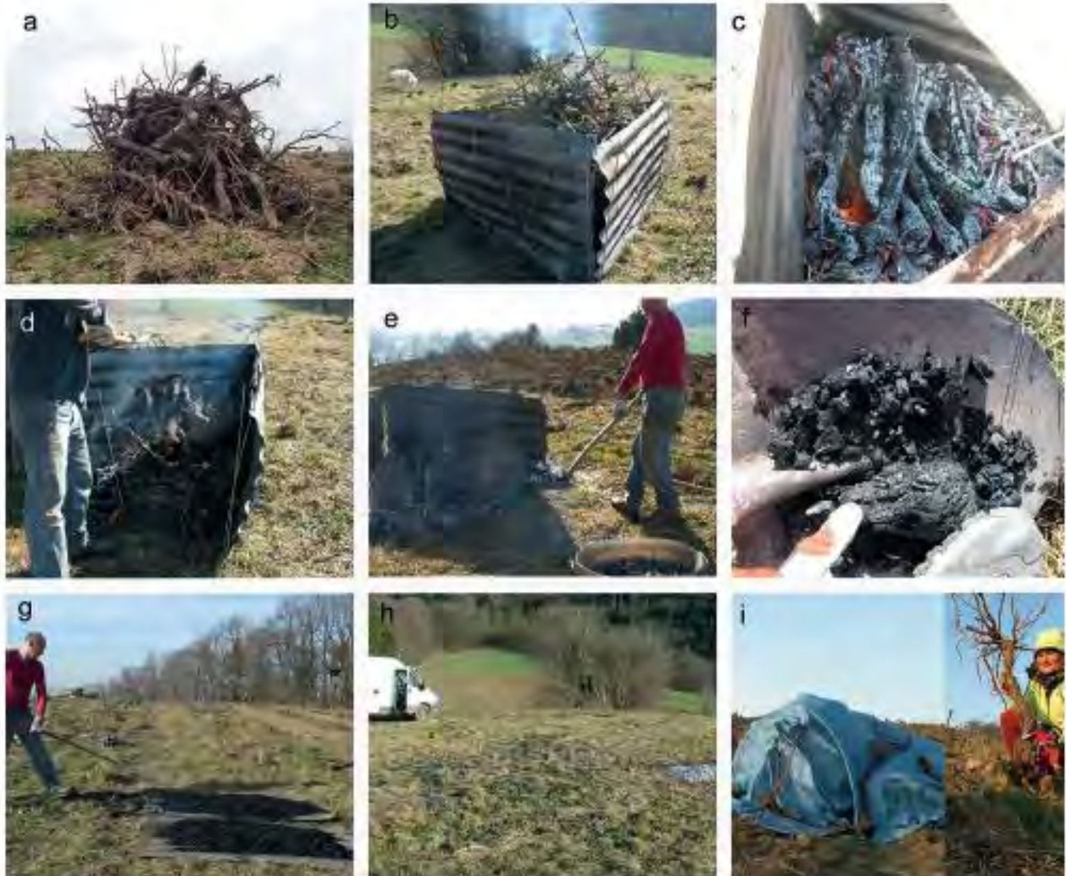
Abb. 3: Abfolge der Probeverkohlung per Wellblech-Meiler. a: Knapp 1 m 3 Rebholz von 1,5 Ar stehen bereit; b: Drei Wellbleche zu einem Wall aufgebaut fassen das Material; Reisig wird oben aufgeschichtet und angezündet; c: Nach etwa 2h ist die Hitzeentwicklung komplett, die meisten
