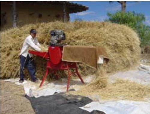
*Para la cosecha de trigo se introdujo el uso de maquinaria para la trilla, pues permite obtener un producto más limpio*
